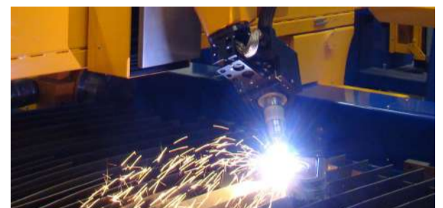
Con el Rotator R5 de MicroStep, se realizan todo tipo de biselés en A, V, Y, K y X en piezas realmente pequeñas donde la interpolación de los ejes es de vital importancia
