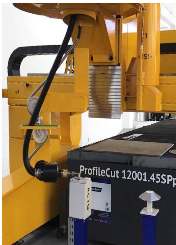
El sistema de calibración ACTG® permite resultados de alta precisión con el cabezal de corte Rotator. Este cabezal de corte 3D especializado con capacidad de inclinación de 120° se mueve alrededor del perfil tanto en dirección longitudinal como transversal.
