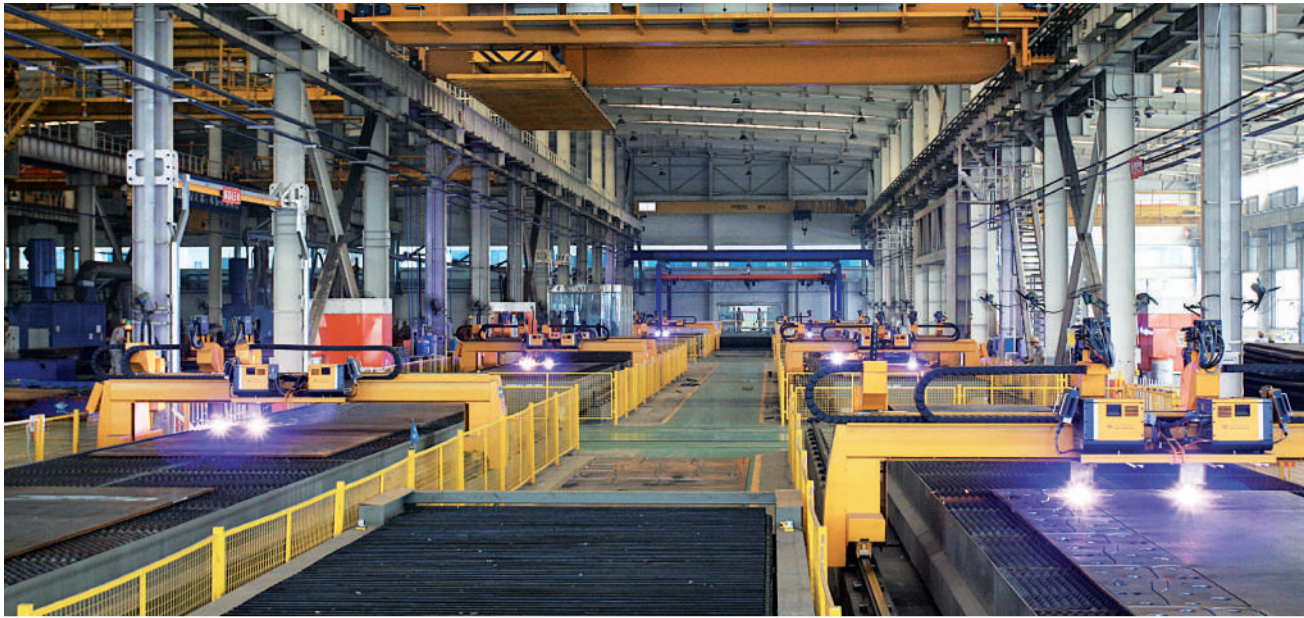
Operación 24/7: la línea de corte automatizada (izquierda) en ZMJ se controla desde una sala de control central (arriba). Una grúa de proceso Demag carga y descarga automáticamente un total de ocho máquinas de corte por plasma CNC de MicroStep.
