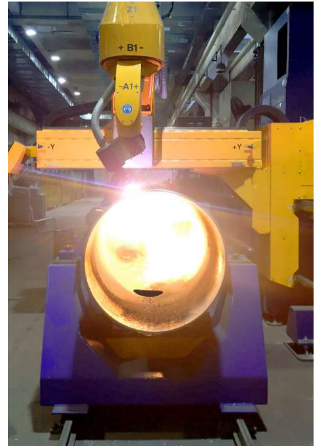
Superior izquierda + derecha: la máquina de corte de tubos y fondos combinada de Gree, PipeCut, permite cortar tubos de hasta 610mm Ø y una longitud de 12 m, así como fondos de hasta Ø 1,200 mm. Abajo a la izquierda: Gree Electric Appliances Inc. fue elegido para participar en proyectos prestigiosos como el Estadio Nacional (Ciudad de fútbol) en Johannesburgo, Sudáfrica.
