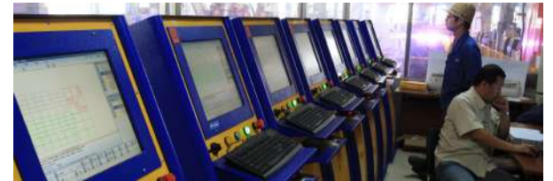
Operación 24/7: la línea de corte automatizada (izquierda) en ZMJ se controla desde una sala de control central (arriba). Una grúa de proceso Demag carga y descarga automáticamente un total de ocho máquinas de corte por plasma CNC de MicroStep.
